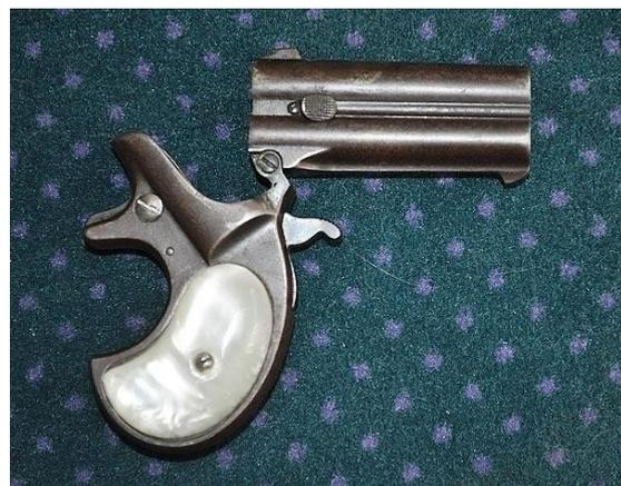
виде оружие заряжалось двумя унитарными патронами. Затем стволы опускались и запирались специального вида защелкой, поворачивающейся на 180 градусов. Для выстрела надо было взвести курок. Конструкция позволяла использовать один курок для двух стволов. При первом взводе ударник срабатывал на один ствол. При последующем взводе – на другой.
